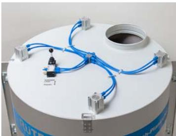
**Pneumatische Siebstapel-Anpressung** (Abb. oben)
